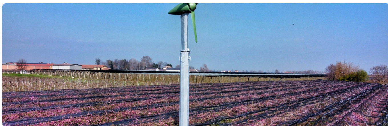
Antibrina 3-22 en instalación fija, con el frutal en plena floración: el momento en que la máquina tiene que estar lista.
